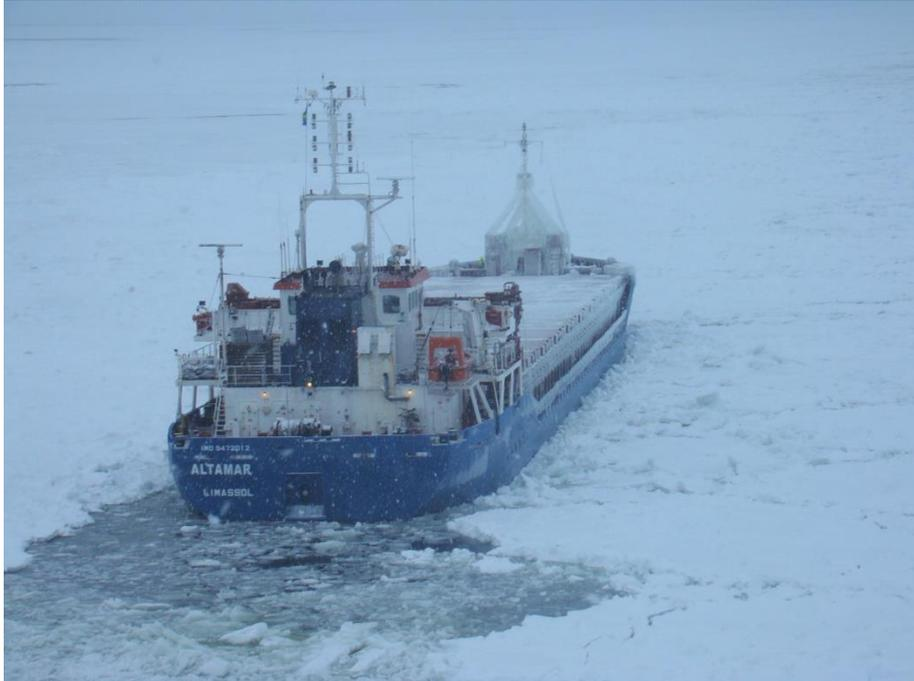
*Navire bloqué par de la glace sous pression. On observe la pression avec les morceaux de glace qui s'agglutinent et commencent à se chevaucher sur la coque du navire.*
